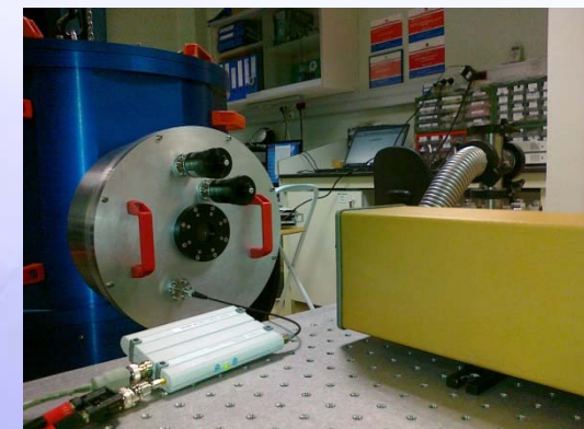
Ensayo Combinado Interferómetro - Criostato
